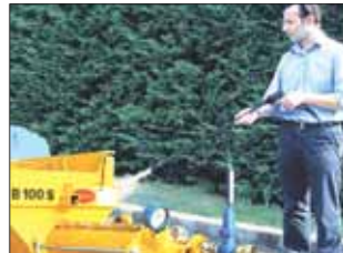
L'unità di pompaggio B100S, collegata ad un adeguato compressore d'aria, genera una spruzzatura costante rendendo il lavoro più pulito e meno faticoso.
